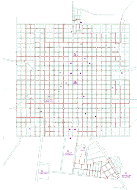
Lámina 27. Red de saneamiento existente en Trinidad. Fuente: OSE / Sistema de Información Geográfico. Intendencia Departamental de Flores- extraído de Plan Local de Trinidad.
